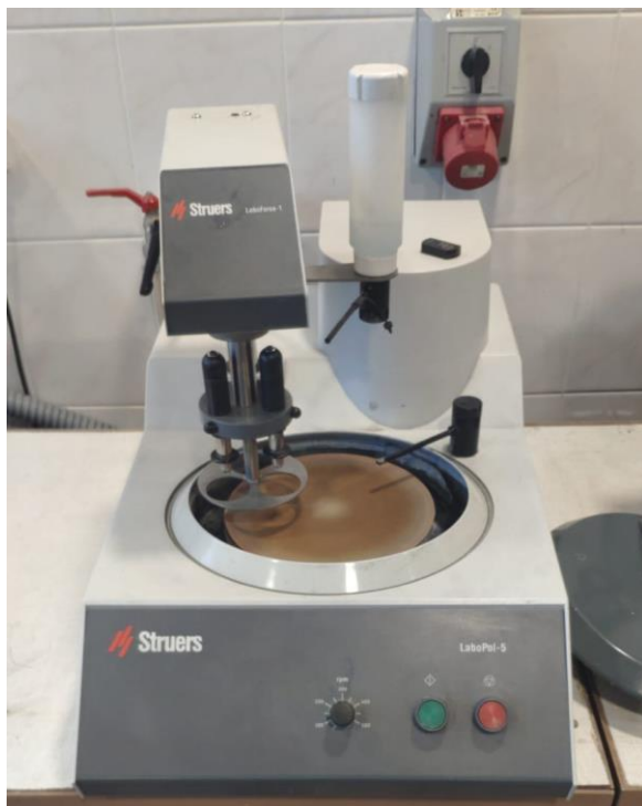
Rysunek 59. Szlifierko-polerka LaboPol 5 (a), automatyczna Szlifierko-polerka firmy STUERS (b).
