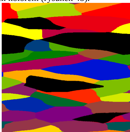
Rysunek 48. Przykładowa reprezentacja mikrostruktury ferrytyczno-perlitycznej.
