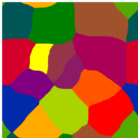
Rysunek 49. Przykładowa reprezentacja mikrostruktury austenitycznej.
