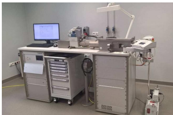
Rysunek 57. Widok ogólny dylatometru DIL805 A/D/T z głowicą pomiarową typu LVDT oraz laserem [autor: IMŻ Gliwice].
