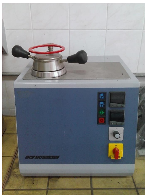
Rysunek 58. Przecinarka do cięcia próbek Brillant 201 firmy PROSPECTA (a). Prasa hydrauliczna do inkludowania próbek na gorąco firmy PROSPECTA (b).
