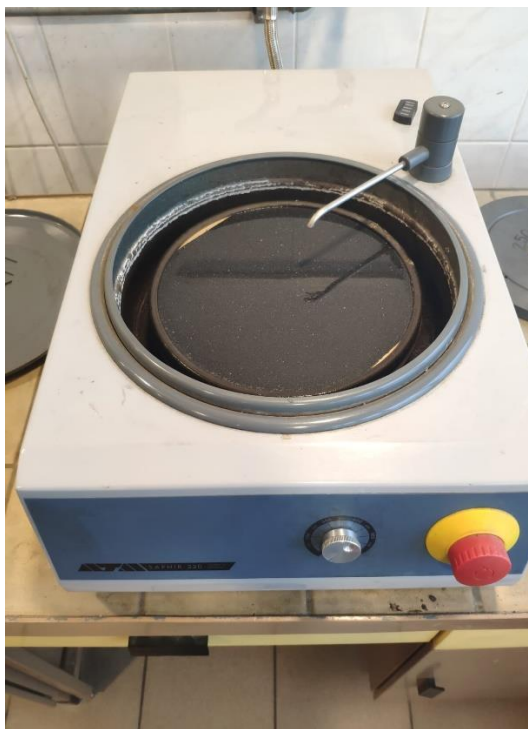
Rysunek 59. Szlifierko-polerka LaboPol 5 (a), automatyczna Szlifierko-polerka firmy STUERS (b).
