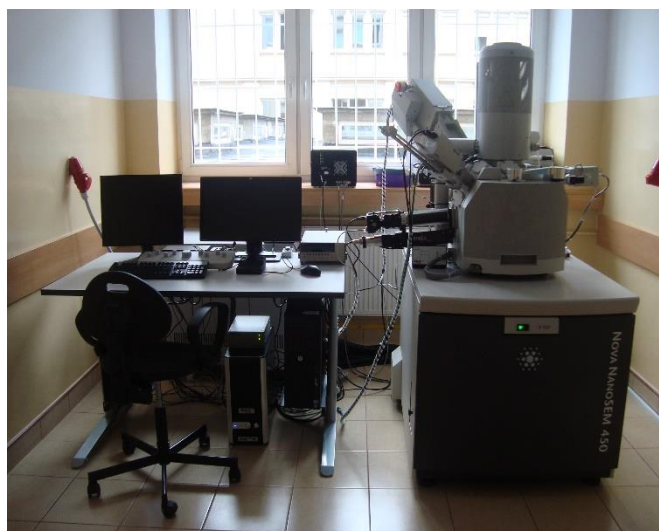
Rysunek 61. Skaningowy transmisyjny mikroskop elektronowy FEI Nova NanoSEM 450 (STEM), przystawka analizująca WDS „IBEX” oraz przystawka EBSD.
