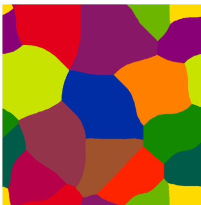
Rysunek 65. Cyfrowa reprezentacja mikrostruktury stali SJ235.
